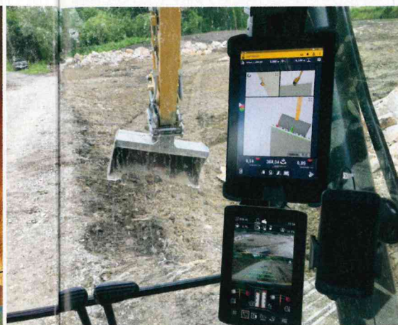
Der Einsatz von Kameras, Sensoren und anderen Datenerfassungstechnologien zur Realitätserfassung und Visualisierung der Baustelle ermöglicht die zentimetergenaue Umsetzung des digitalen Modells.
